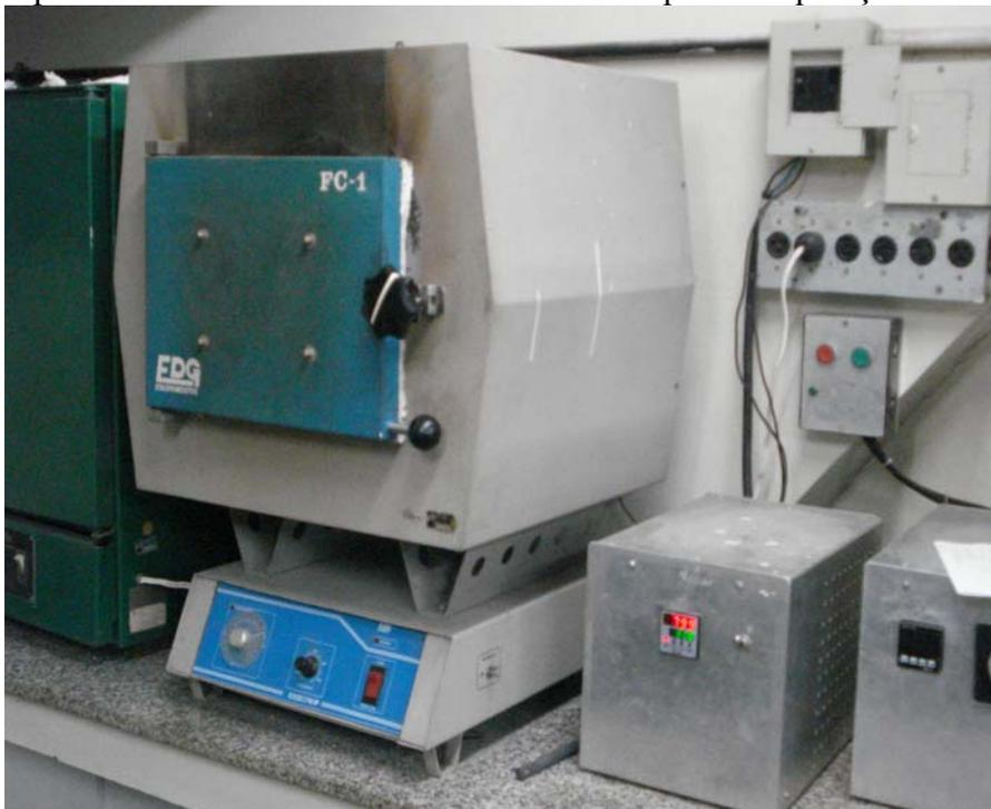
**Figura 3:** Forno utilizado no tratamento térmico das amostras, em temperaturas de até 1000°C.
