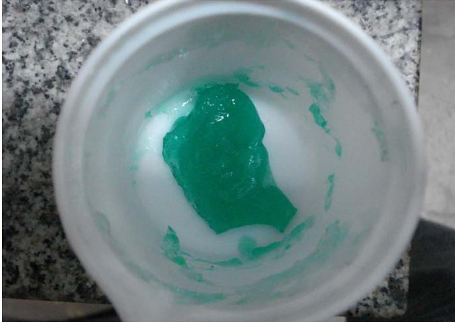
**Figura 2:** Foto da amostra já adicionado o nitrato de níquel e nitrato de magnésio, após passar pelo aquecimento de aproximadamente 15 horas atingindo assim, altíssima viscosidade.
