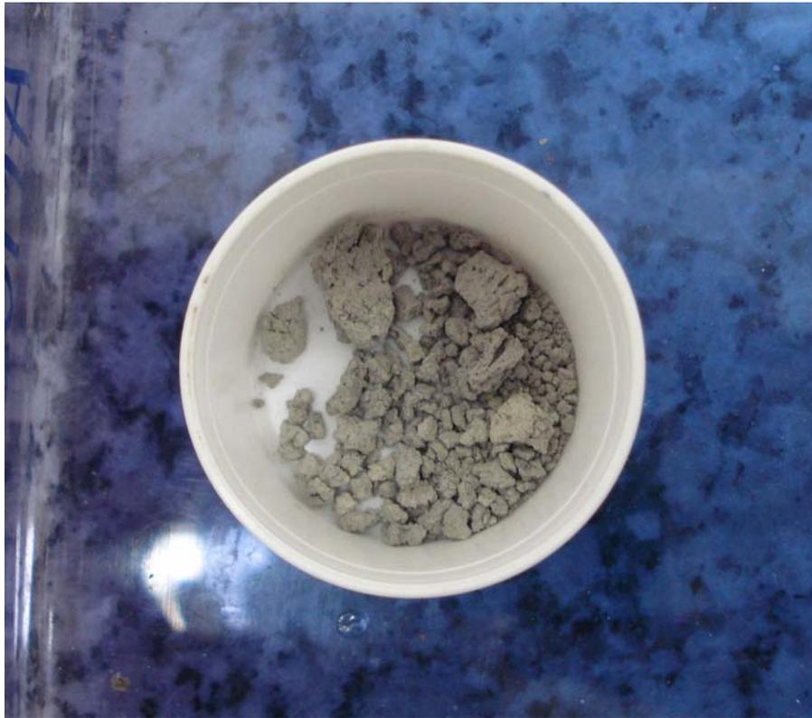
**Figura 4:** Amostra pronta, após todo o processo de preparo com tratamento térmico a uma temperatura de 700°C, durante 60 min.
